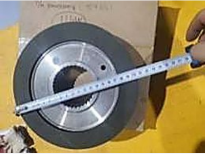
브레이크라이닝 지름206MM BFK458-20E 11KW
