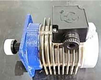
브레이크 한선제품 60Hz 380V 0.22A 0.85Nm 720RPM
