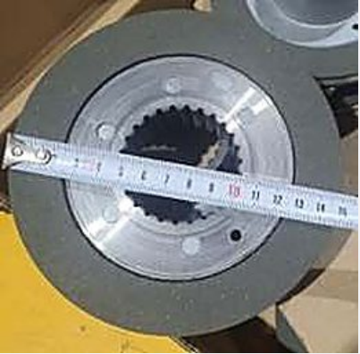
브레이크라이닝( INTORQ ) 지름 148MM BFK458-16E 5.5KW 7.5KW
