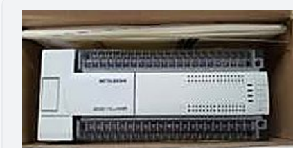
미쓰비시 PLC FX2N-64MR AC85~264V 50/60Hz
